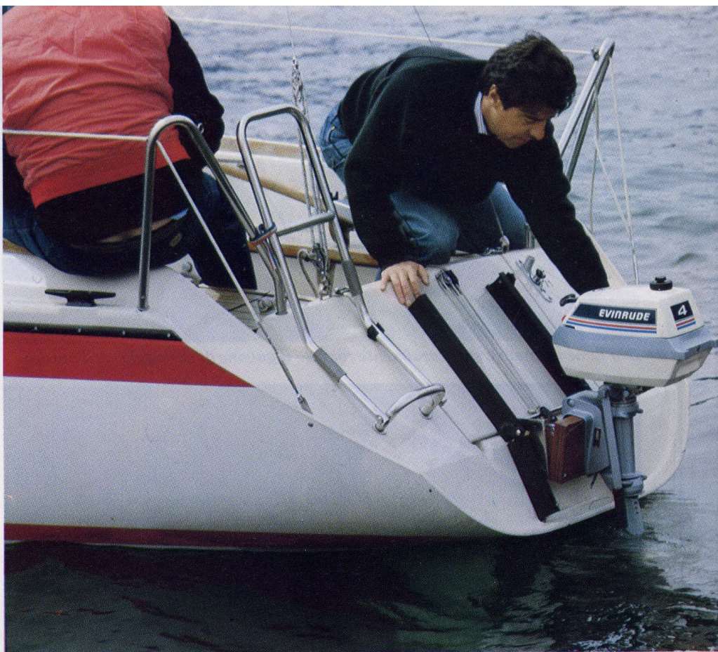
Abbastanza comoda la manovra di avviamento del motore fuoribordo, applicato allo specchio di poppa con supporto e rotaia per il sollevamento. Pratico il paranco per azionare senza sforzi il meccanismo.
