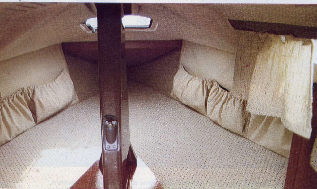
Cuccetta a 'V' di prua con cassa di deriva ermeticamente chiusa. Il tirante che si vede nella foto aziona il tappo che al momento dell'alaggio scarica l'acqua dalle casse di zavorra.
